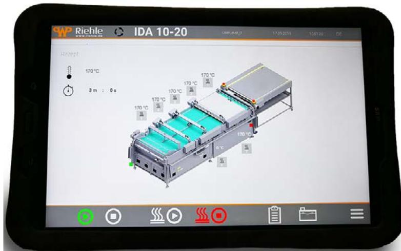
Alle Komponenten der IDA werden zentral über eine Steuerung bedient, diese ist internet- und fernwartungsfähig. In der Software können verschiedene Benutzerlevel mit entsprechenden Zugriffsrechten hinterlegt werden. Die Steuerung der IDA ist auch über ein Tablet möglich.
