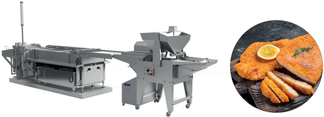
Bild: DLA 600 SC mit vorgeschalteter Panieranlage
